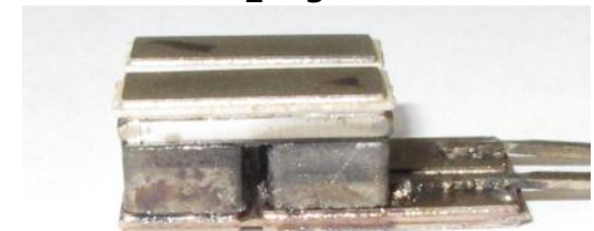
0.1mm Fe + 1mm Ni + Ni/Cu/Al 2 O 3 /Cu/Ni
